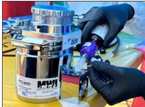
**Figure 4.5.** Remplisseur d'entonnoir anti-déversement monté sur la bouteille d'isoflurane pour le verser dans le réservoir.
